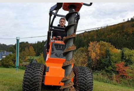
Erdbohrer in verschiedenen Breiten z.B. für den Zaunbau
