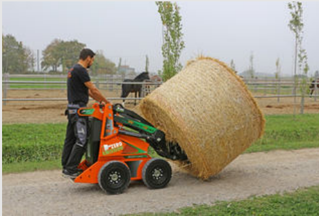
Mit Kontergewichten ist eine Hublast von bis zu 450 kg möglich
