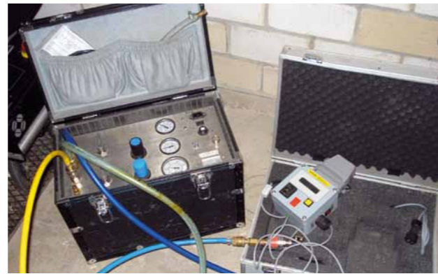
Druckprüfung für Abwasserkanäle
