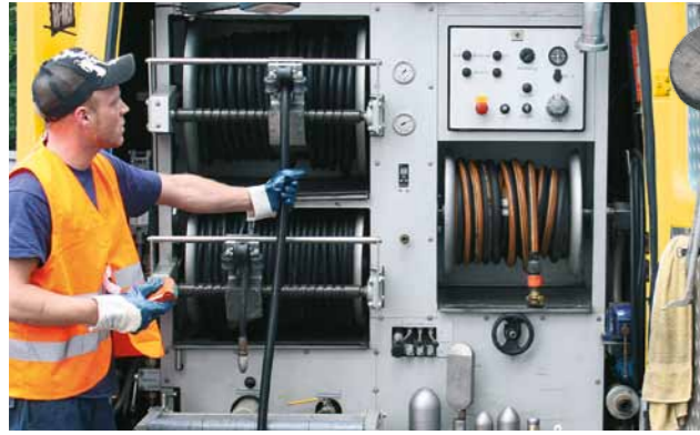
Einsatzfahrzeug bestückt mit Hochdruck-Spülaggregat
