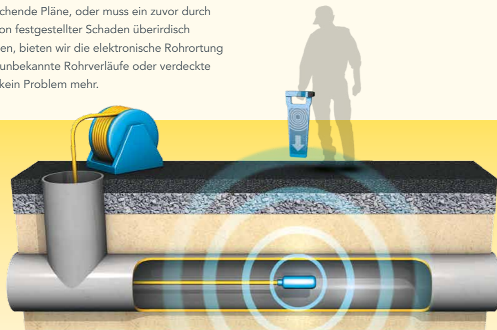
Elektronische Rohrortung mit einem Sender im Rohr.
