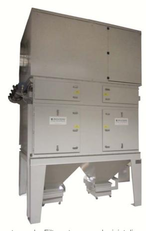
Die Steuerung der Filteranlage überwacht die Verschmutzung der Filterpatronen und reinigt diese zur gegebenen Zeit automatisch mit Druckluft (Jet-Impuls) ab. Der abgereinigte Staub fällt in den fahrbaren Staubsammelbehälter. Von hier aus kann der Staub problemlos entsorgt werden.
