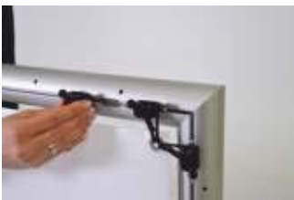
Mausbinder in die Nut des Rohres stecken
