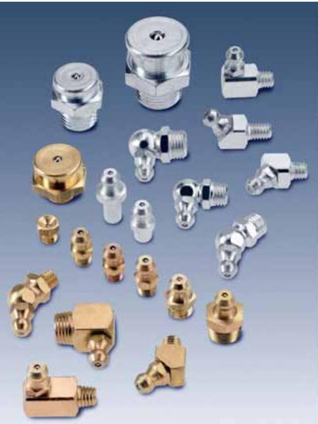
Aber zurück zur ersten Frage. Tatsächlich sorgen Schmiernippel überall auf der Welt für den „leichten Lauf“ von Mähreschern, Gabelstaplern, großen und kleinen Maschinenanlagen. Schmiernippel funktionieren wie folgt: So wie über ein Ventil Luft in einen Fahrradschlauch gelangt, kann über einen Nippel Öl oder Fett in ein quiet-schendes Kugellager oder Scharnier gepresst werden. Dabei sind alle Reibungspunkte stets optimal ge-
