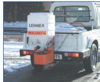
POLARO® 100 am Pritschenfahrzeug mit Schneeräumschild
