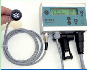
Verbindungskabel 2 m „7-poliger Stecker“
