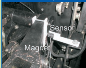
Vorgewende-Manager 4m „Sensor mit Magnet“
