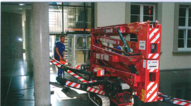
Erst klein - diese Hebebühne passt durch eine normale Eingangstür.
