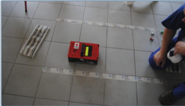
Sachverständigen Hans Grasser über das nötige Know-how. In diesem Fall mit einer Prüfmethode zur Bestimmung der Rutschhemmung (Gleitreibungs-Koeffizient). Die zu messende Teststrecke wird abgeklebt, um anschließend präzise Messwerte über die Haft- und Gleitreibung zu bekommen.
