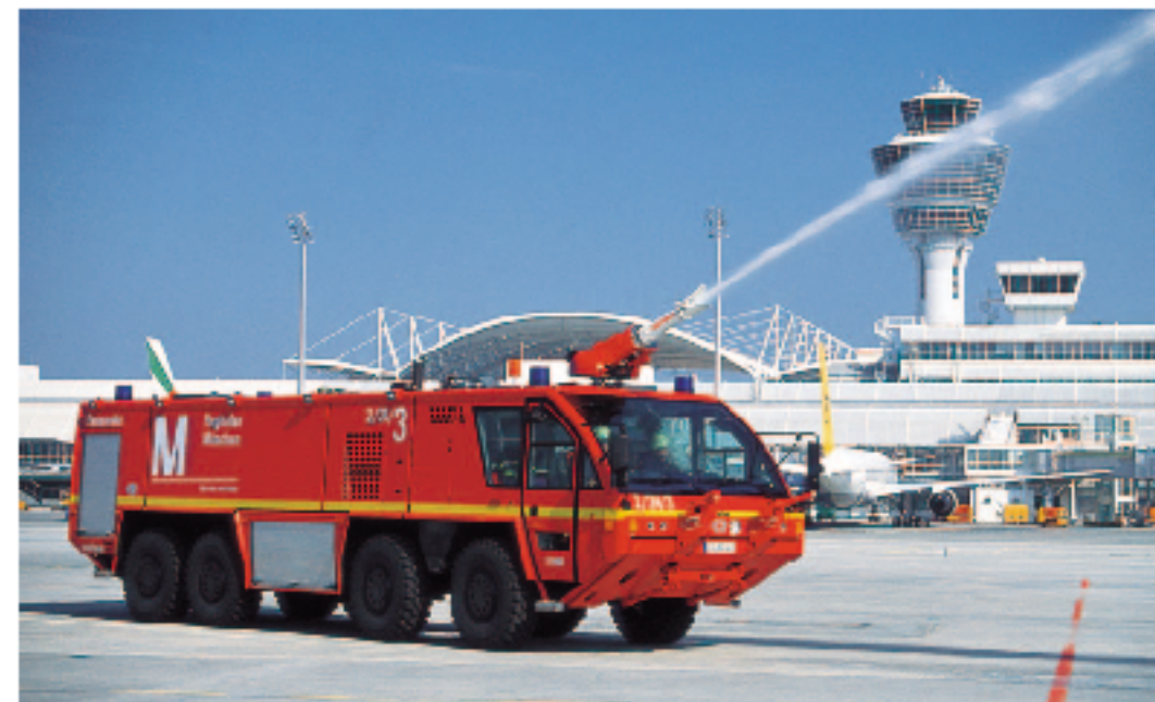
„Panther AT“ für den Vorfeldbrandschutz: Gesamtgewicht 40 t, V 12-Dieselmotor mit 1 000 PS, separater Pumpenmotor mit 311 PS, Wurfweite Dachwerfer bis 90 m, Pulveranlage 1 000 kg/30 bar, Frontwerfer für Pulver 20 kg/sec, Wurfweite 30 m
