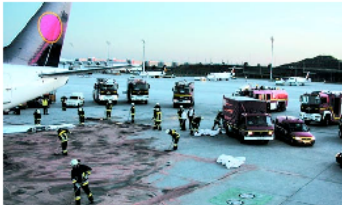
Übertankung: Ausgelaufenes Kerosin wird mit Bindemittel aufgenommen
