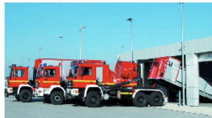
Drei Wechselladerfahrzeuge transportieren die erforderlichen Abrollbehälter
