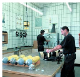
In dieser Werkstatt werden ca. hundert Atemschutzgeräte geprüft, gewartet und gepflegt
