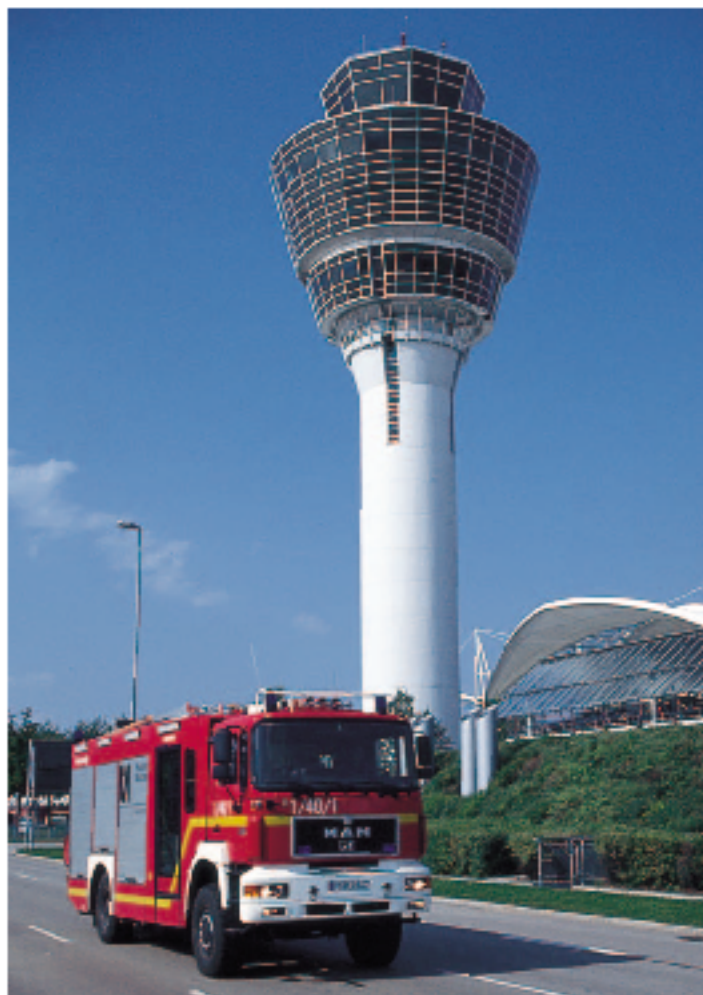
Hilfeleistungslöschfahrzeug HLF: Gesamtgewicht 18 t, 400 PS, Pumpenleistung 2 400 l bei 8 bar, Dachmonitor FM 24M, Durchflussmenge bis 2 400 l, Schnellangriff mit 90 m HD-Schlauch, 300 (40 bar)
