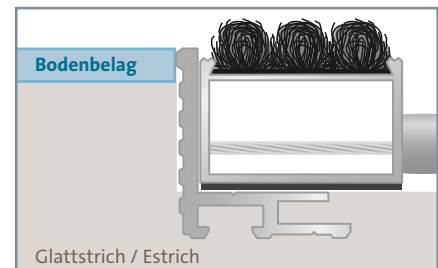
Montage: Der Winkelrahmen muss bündig mit Bodenbelag und Glattstrich / Estrich abschließen
